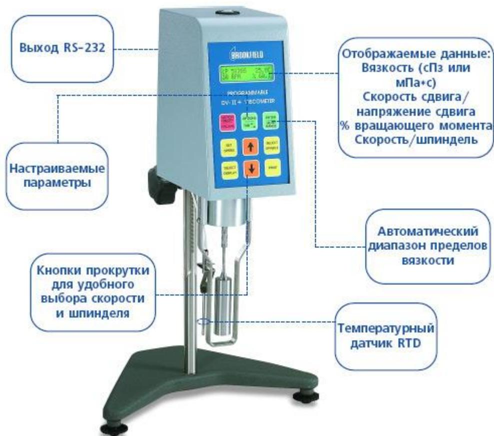
Рис. 14. Цифровой вискозиметр Брукфильда – вискозиметр серии DV-II+Pro
