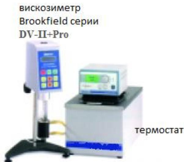
Рис. 15. Цифровой вискозиметр Брукфильда – вискозиметр серии DV-II+Pro
